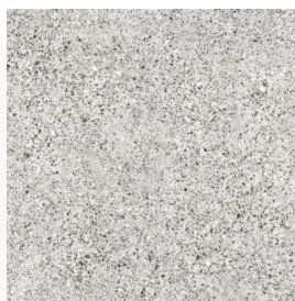
Figura 2, piso em granilite na cor branco
